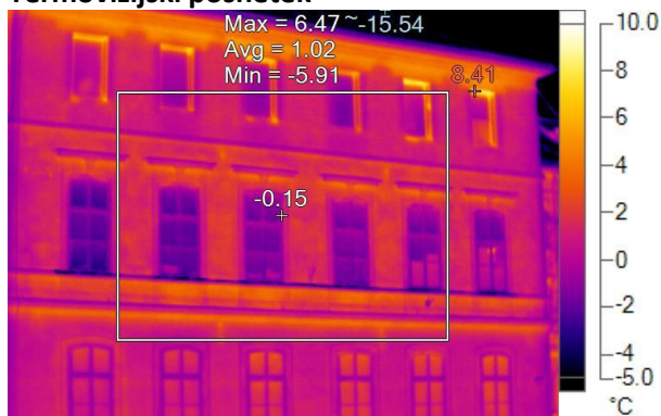
Preglednica 7.1: Termovizijski posnetek s komentarjem – južna fasada, 2.nadstropje
