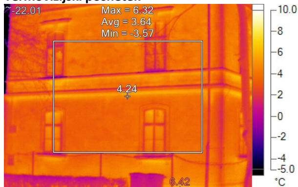
Preglednica 7.6: Termovizijski posnetek s komentarjem – severozahodna fasada
