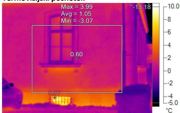
Preglednica 7.2: Termovizijski posnetek s komentarjem – okna v pritličju, JZ fasada
